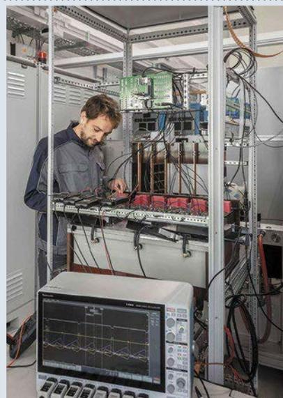
**Aufbau und Test des SiC-Wechselrichter-Stack in den Labors des Fraunhofer ISE**
