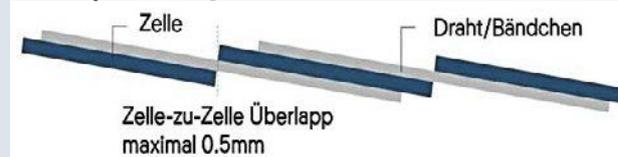
Keine Lücken mehr zwischen den Zellen: Hanwha Q Cells hat mit der Baureihe »Q.PEAK DUO-G9« Ende 2020 seine ersten Module mit der »Zero-Gap«-Technologie auf den Markt gebracht
