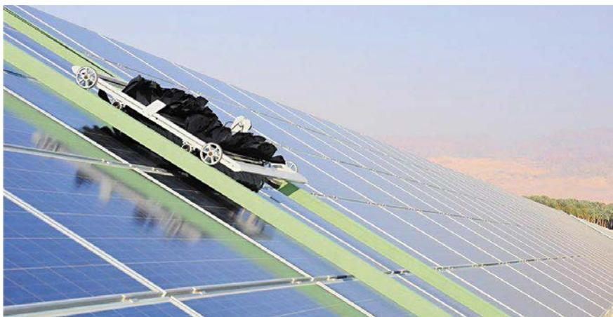
Im Einsatz: Reinigungsroboter von Ecoppia
