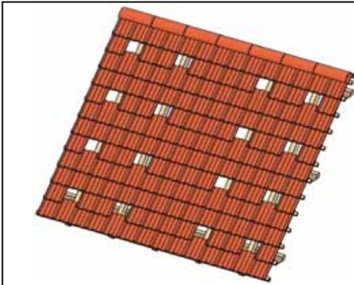
Position der Dachhaken wählen. Im Randbereich des Modulfeldes die ersten beiden Sparren, je einen Dachhaken anbringen. Anschließend je nach Statik jeden oder jeden 2. Sparren mit einem Dachhaken versehen. Hierbei ist auf die maximale Spannweite der Schiene bei gegebener Schneelast zu achten. Gegebenenfalls muss der Abstand verringert werden.
