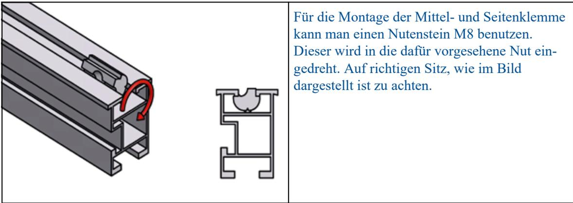
Für die Montage der Mittel- und Seitenklemme kann man einen Nutenstein M8 benutzen. Dieser wird in die dafür vorgesehene Nut eingedreht. Auf richtigen Sitz, wie im Bild dargestellt ist zu achten.
