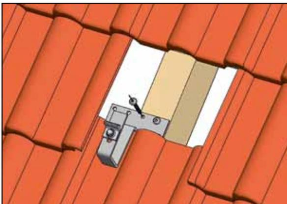
Dachhaken mit mindestens 2 Tellerkopfschrauben 8 x Länge OHNE vorbohren befestigen und Ziegel nach Montage wieder eindecken
