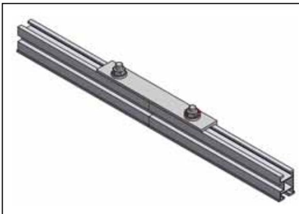
Bei dem zu verbindenden Profil den Vorgang wiederholen. Bei einer Profillänge von >18 mtr. ist eine Trennung von min. 100 mm für eine Längenausdehnung vorzusehen.
