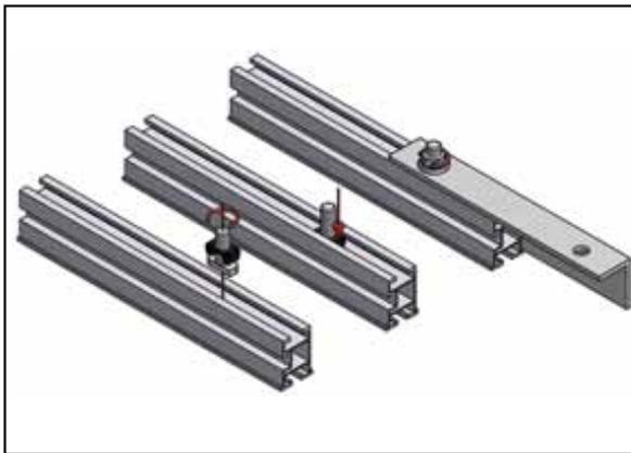
Bei der Montage eines Profilverbinders wird die Hammerkopfschraube M10 in die Hammerkopfnut eingedreht. Folgend wird der Profilverbinder montiert und mit der Sperrzahnmutter M10 angezogen.
