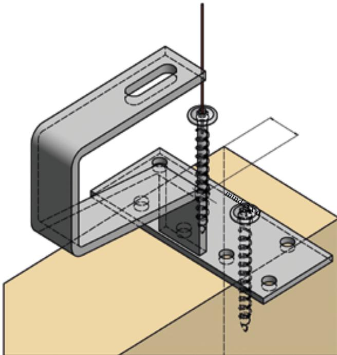
Zu unseren Dachhaken werden, in so fern nicht anders erwünscht, 8 mm Tellerkopfschrauben geliefert. Bei der Befestigung mit der Schraube ist nach DIN1052 ein Abstand vom Sparrenrand wie im Bild dargestellt einzuhalten. Hierbei ist ein dreifacher Abstand des Durchmessers der Schraube notwendig.
