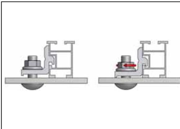
Darauf achten, dass die Klemmnut der Montageprofil in den am Dachhaken vormontierten Klemmstein einhakt. Nach Ausrichten des Montageprofils Sperrzahnmutter anziehen bis der Klemmstein das Montageprofils fixiert.
