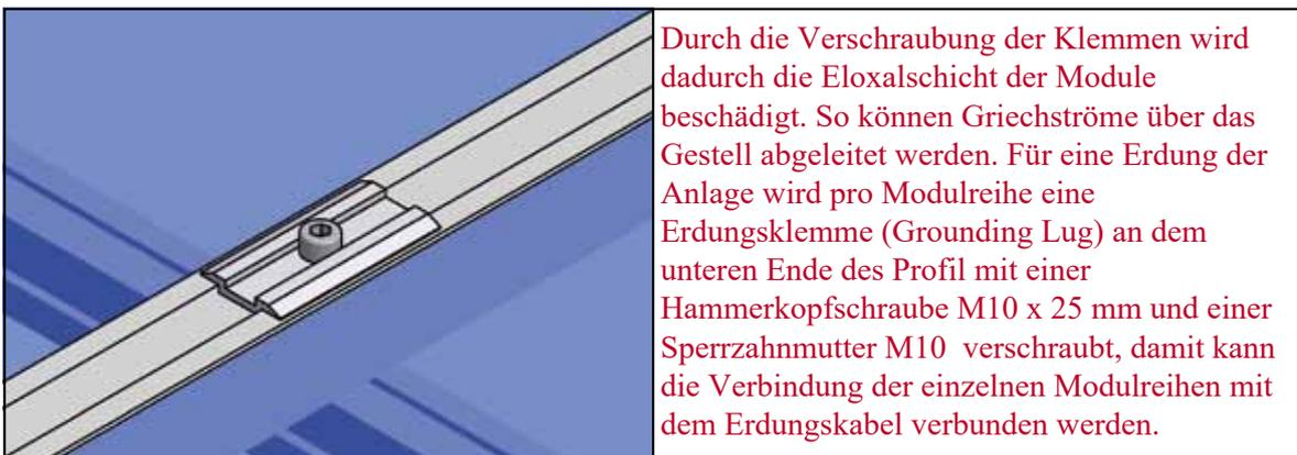
Durch die Verschraubung der Klemmen wird dadurch die Eloxalschicht der Module beschädigt. So können Griecheströme über das Gestell abgeleitet werden. Für eine Erdung der Anlage wird pro Modulreihe eine Erdungsklemme (Grounding Lug) an dem unteren Ende des Profil mit einer Hammerkopfschraube M10 x 25 mm und einer Sperrzahnmutter M10 verschraubt, damit kann die Verbindung der einzelnen Modulreihen mit dem Erdungskabel verbunden werden.
