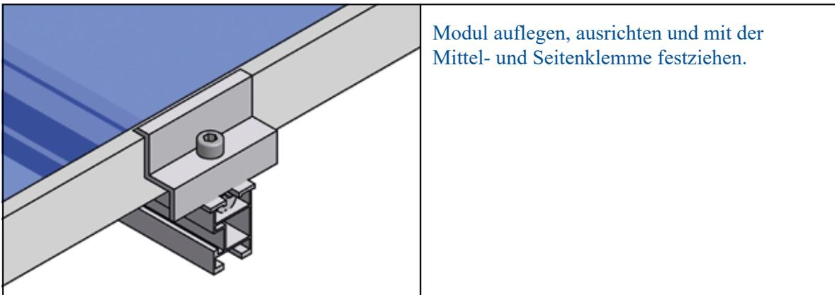
Modul auflegen, ausrichten und mit der Mittel- und Seitenklemme festziehen.
