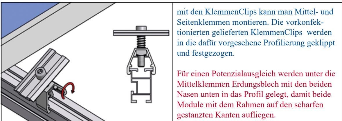
mit den KlemmenClips kann man Mittel- und Seitenklemmen montieren. Die vorkonfektionierten gelieferten KlemmenClips werden in die dafür vorgesehene Profilierung geklippt und festgezogen.
